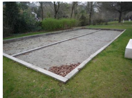
☹ Terrain de pétanque non relié à l'allée par un cheminement accessible
