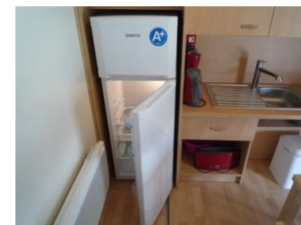
😞 Tous les détails sont essentiels. Y compris ce réfrigérateur d'un chalet accessible et dont la porte ouvre dans le mauvais sens
