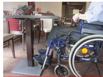
⊗ La profondeur de la table est insuffisante. Les cales pieds buttent dans le pied de table et la personne n'est pas installée confortablement pour déjeuner (trop loin du bord de la table)
